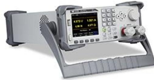
Las cargas electrónicas se utilizan típicamente para proporcionar una carga a las salidas de una fuente de alimentación, generalmente con capacidad de carga dinámica y son completamente programables. Las cargas electrónicas ayudan a los diseñadores a probar productos de energía electrónica y garantizar calidad, confiabilidad y rendimiento.
